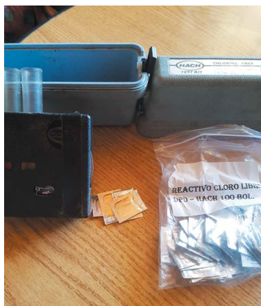
Analizador de cloro en agua
