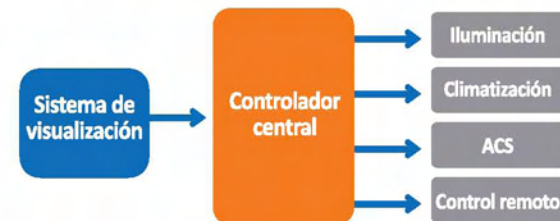
Figura 3.2.25 Ejemplo esquema sistema BMS
