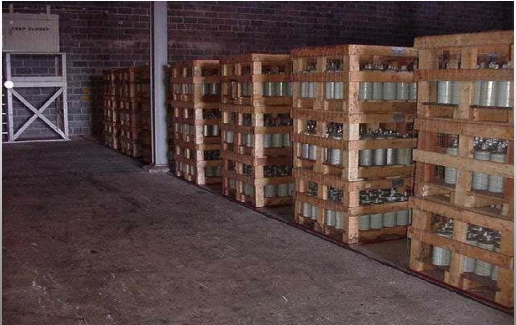
Método del almacenamiento previo - frascos almacenados directamente sobre pallets (FUENTE: DNSC, 2007)
